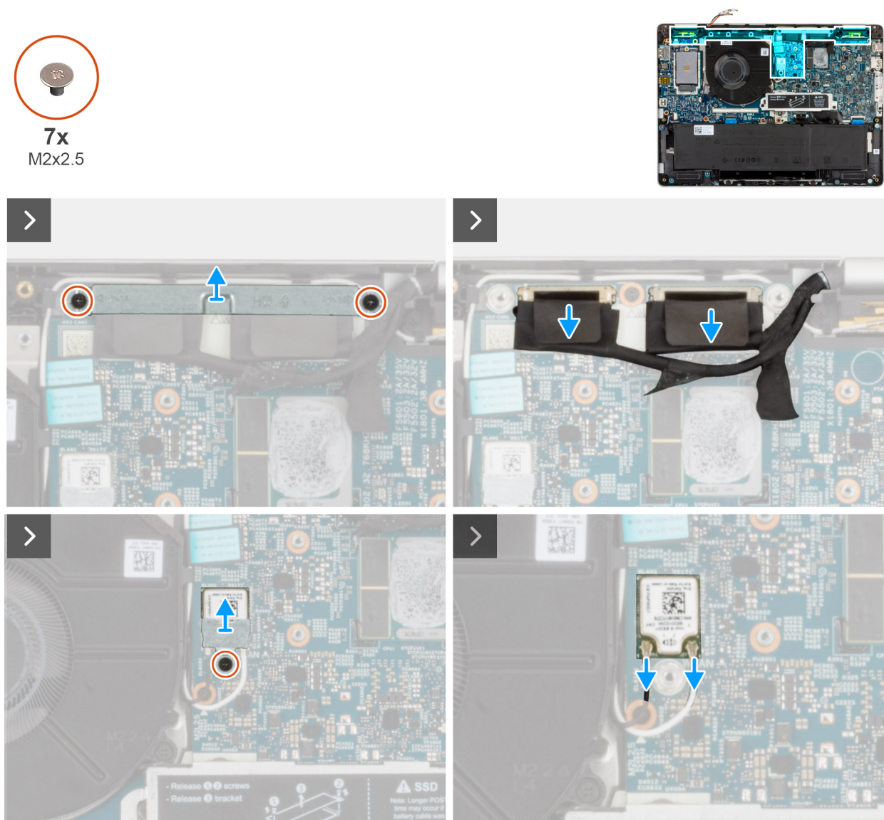
Figur 50. Ta bort WLAN-antennmodulen
