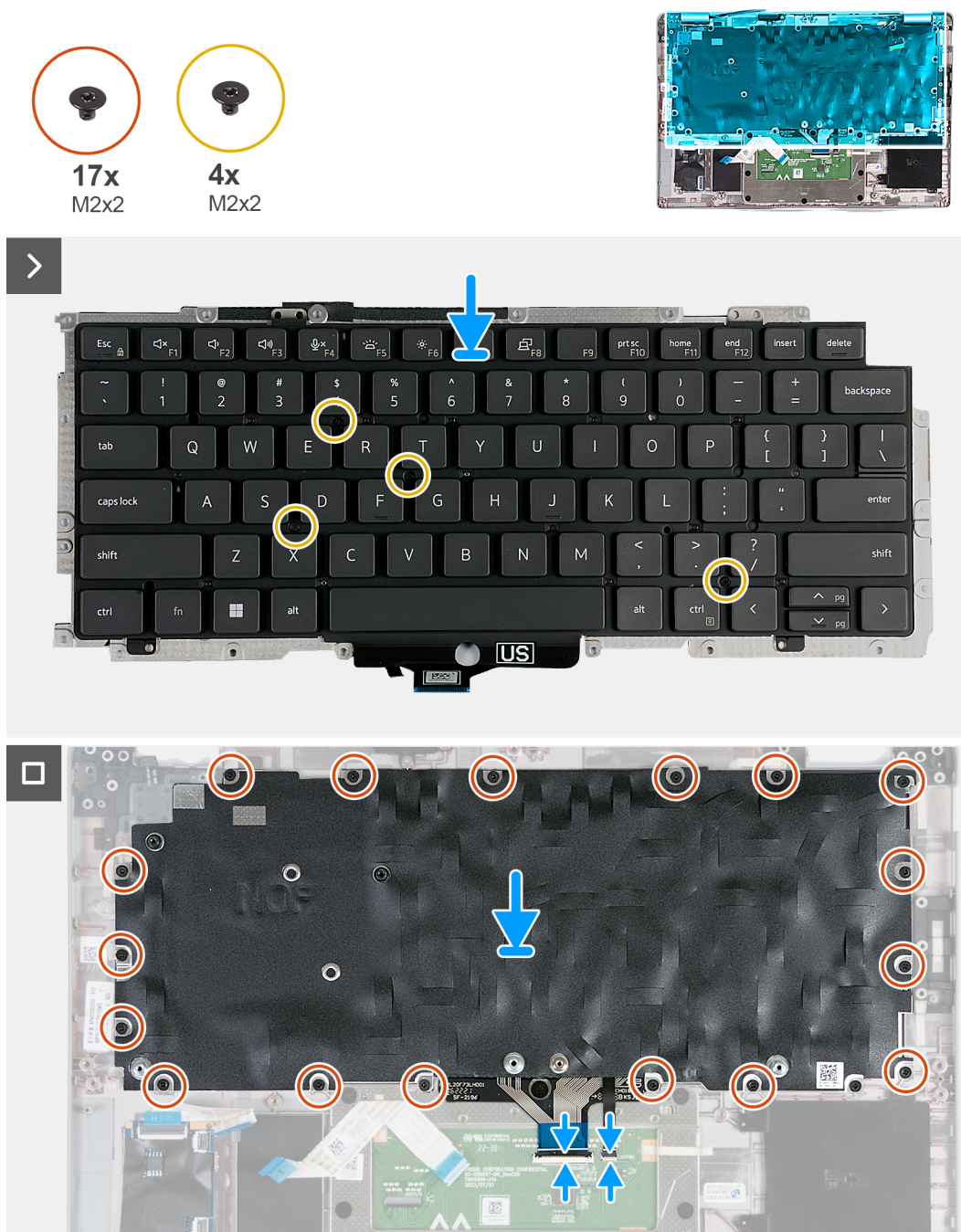
Figur 62. Installera tangentbordet
