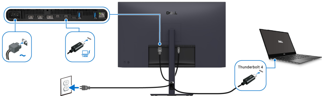
Bild 45. Ansluta Thunderbolt 4 aktiv kabel för DPBS
