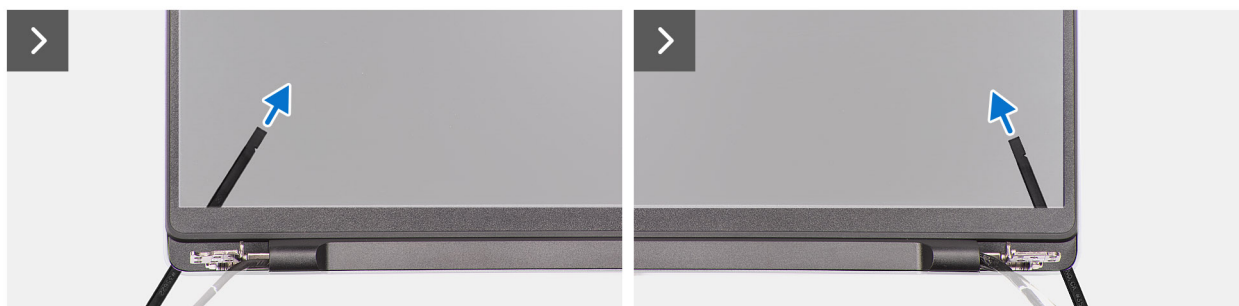
Figur 49. Removing the display bezel
