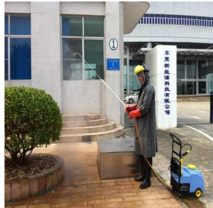
图片 2 水雾灭火器 (穿着 PPE 防止触电)
