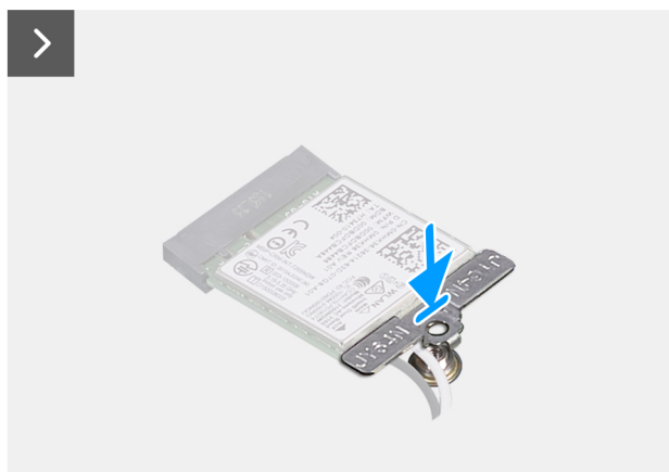
Figur 28. Installera det trådlösa kortet
