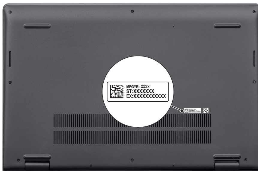
Figur 7. Plats för service tag eller expresstjänstkod
