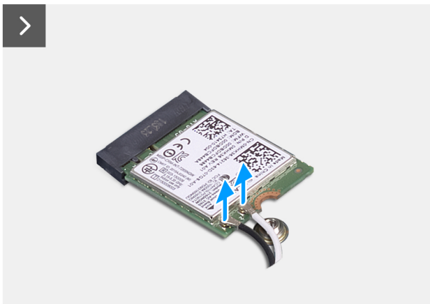
Figur 33. Ta bort det trådlösa kortet
