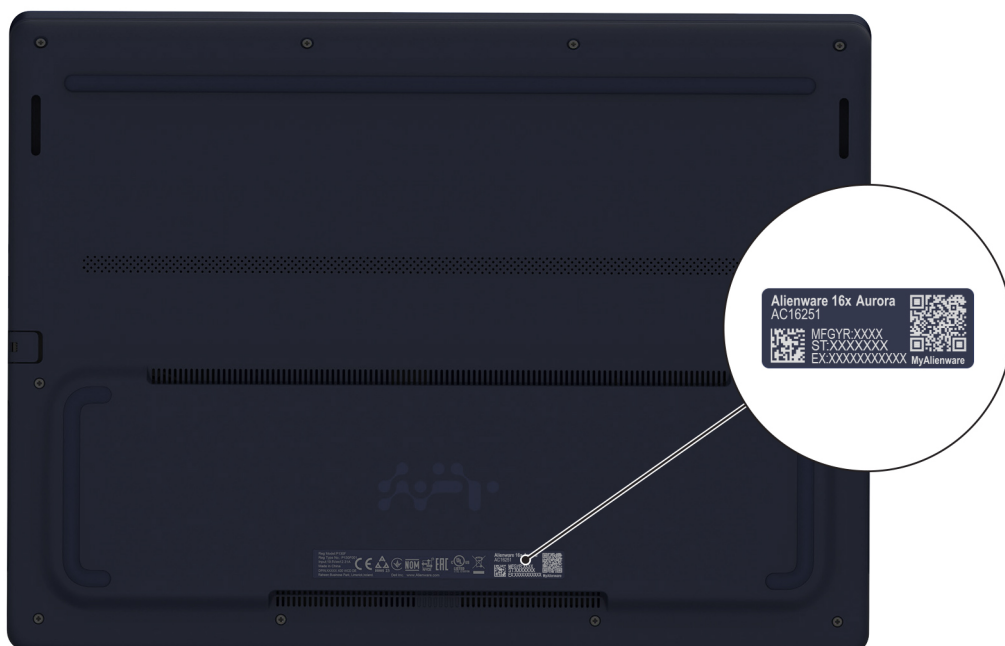
Figur 7. Plats för service tag eller expresstjänstkod
