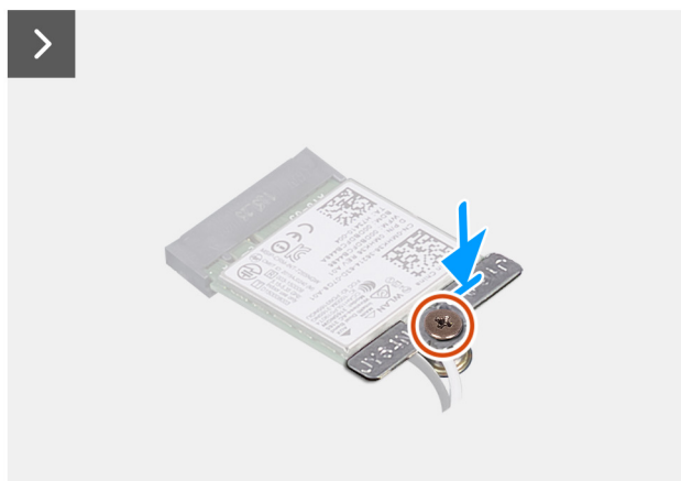
Figur 34. Installera det trådlösa kortet
