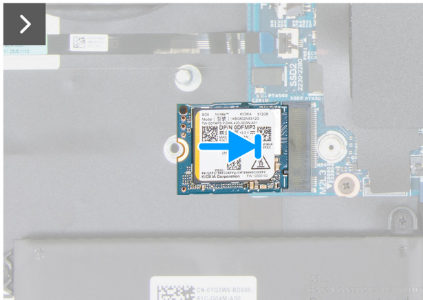
Figur 26. Installera M.2 2230 SSD-disken i SSD2-kortplatsen
