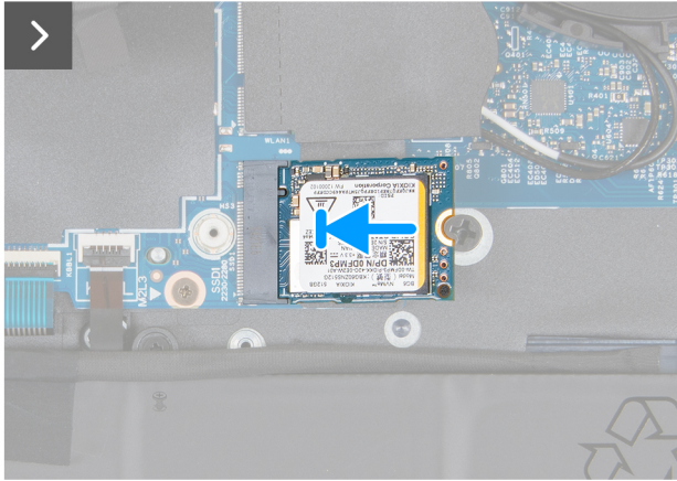
Figur 24. Installera M.2 2230 SSD-disken i SSD1-kortplatsen
