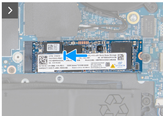
Figur 28. Installera M.2 2280 SSD-disken i SSD1-kortplatsen
