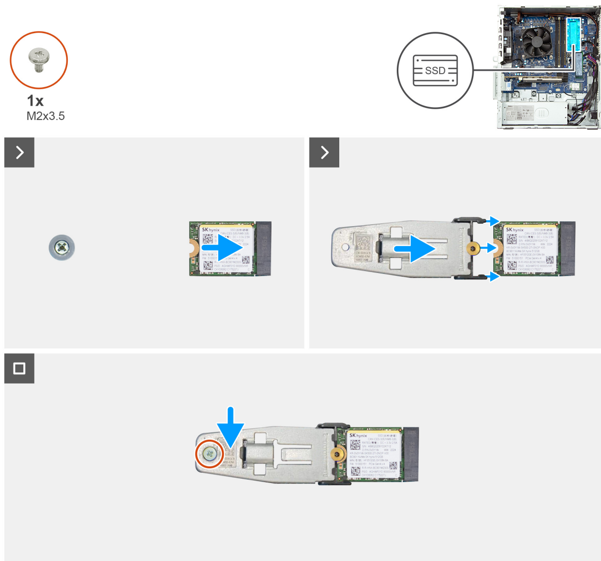
Figur 37. Installera M.2 2230 SSD-disken i kortplats 2
