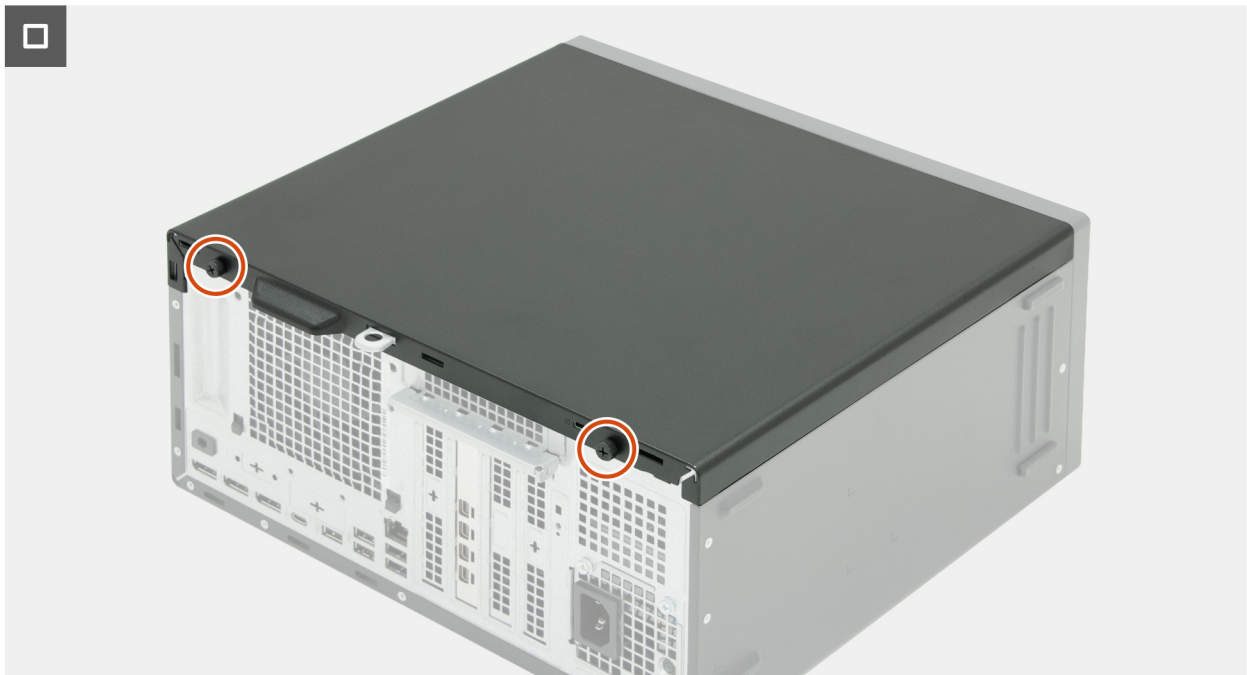
Figur 16. Installera den vänstra kåpan
