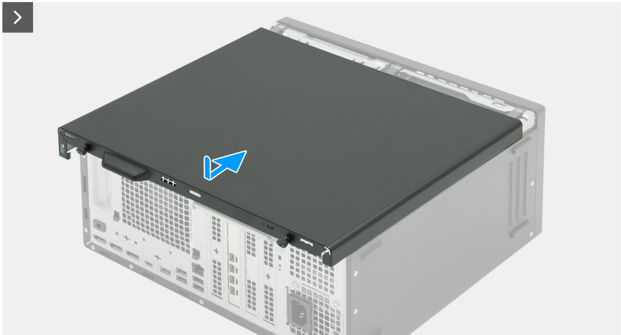
Figur 15. Installera den vänstra kåpan
