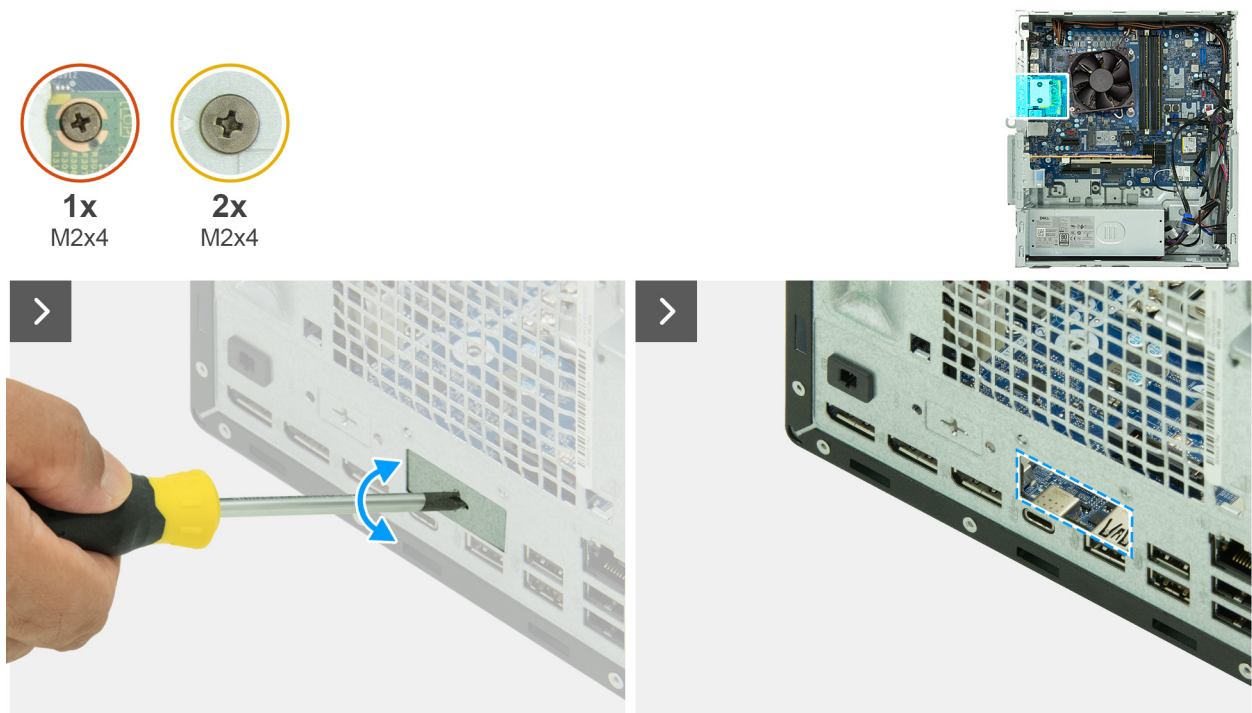
Figur 79. Installera den fiberoptiska portmodulen
