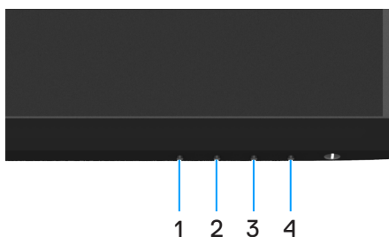
Bild 41. Funktionsknappar för Inbyggd diagnostik
