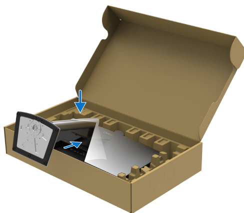
Figur 22. Skjut in flikarna på höjledsjusteringen i spåren
