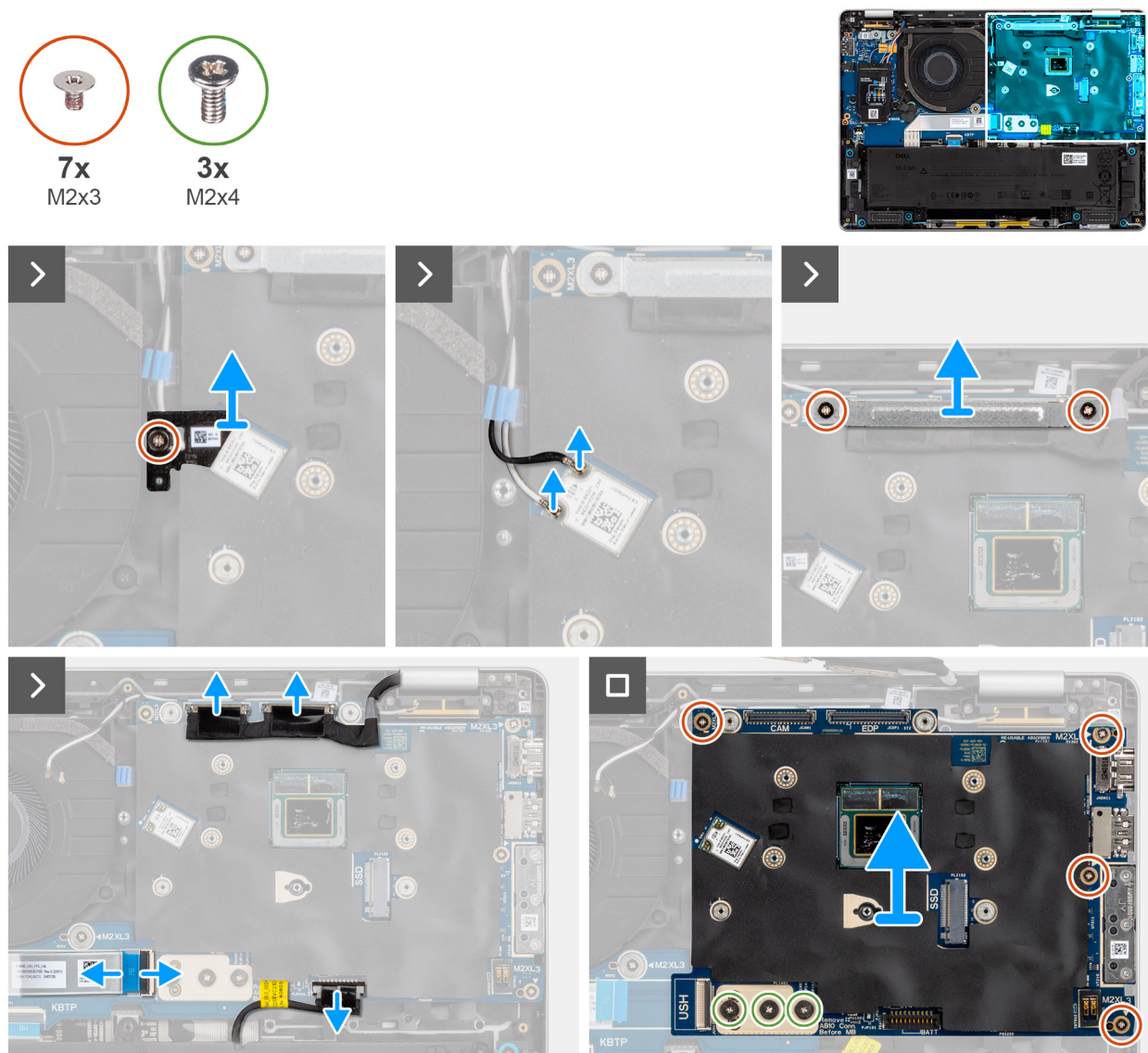
Figur 48. Ta bort moderkortet
