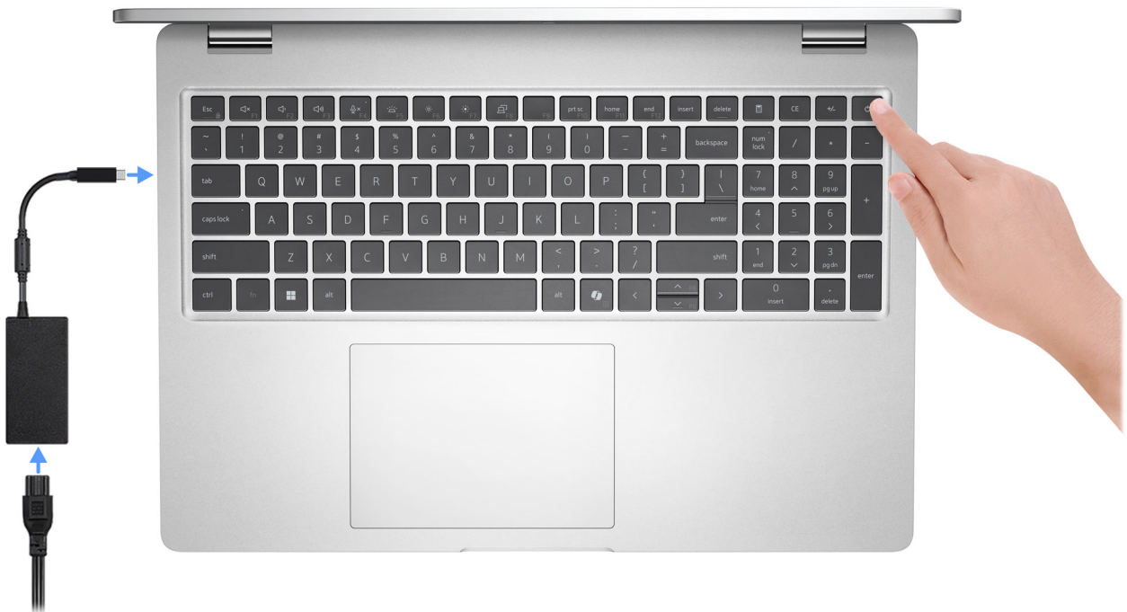
Figur 12. Anslut nätaggregatet och tryck på strömbrytaren.
