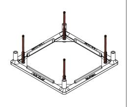
2 然后放上120x25mm的风扇,使防震支架的尖端 穿过风扇的安装孔位。 往上推动防震支架, 直到标示为5的棘爪完全通过。
