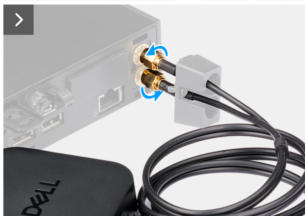
Figur 34. Ta bort extern puckantenn
