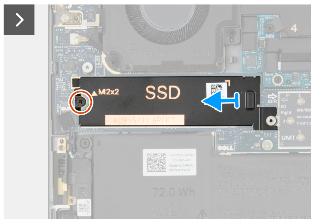
Figur 23. Ta bort M.2 2280 SSD-disken
