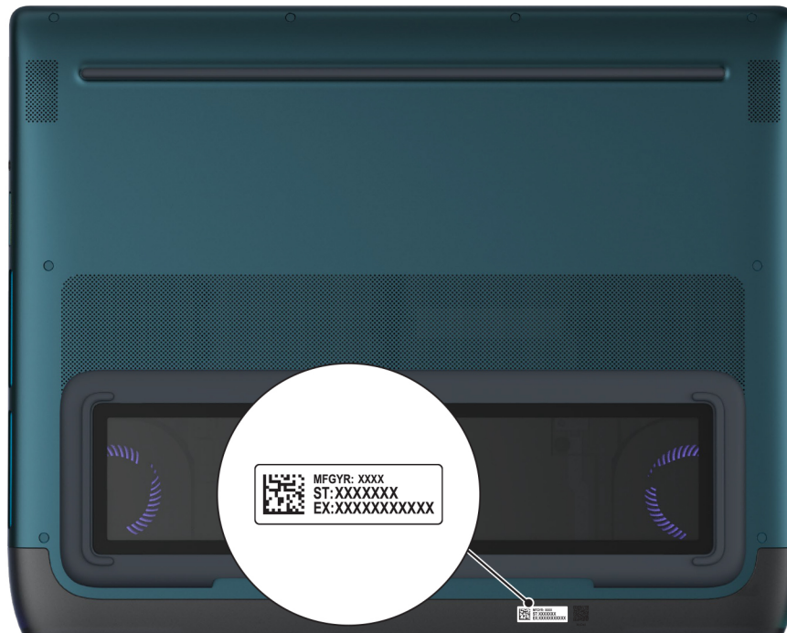
Figur 5. Plats för service tag eller expresstjänstkod
