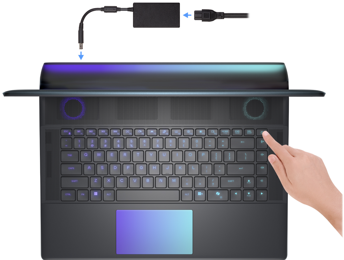
Figur 6. Anslut nätaggregatet och tryck på strömbrytaren
