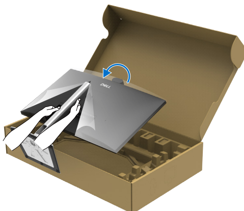
Figur 23. Håll i höjledsjusteringen och lyft bildskärmen
