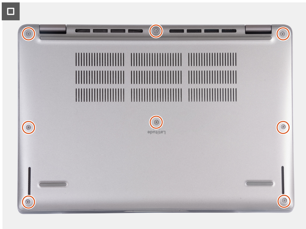
Figur 22. Dra åt de åtta fästskruvarna för att fästa baskåpan i handledsstödet
