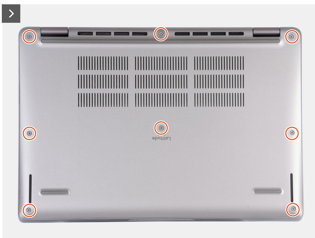
Figur 17. Lossa de åtta fästskruvarna som håller fast baskåpan i handledsstödet
