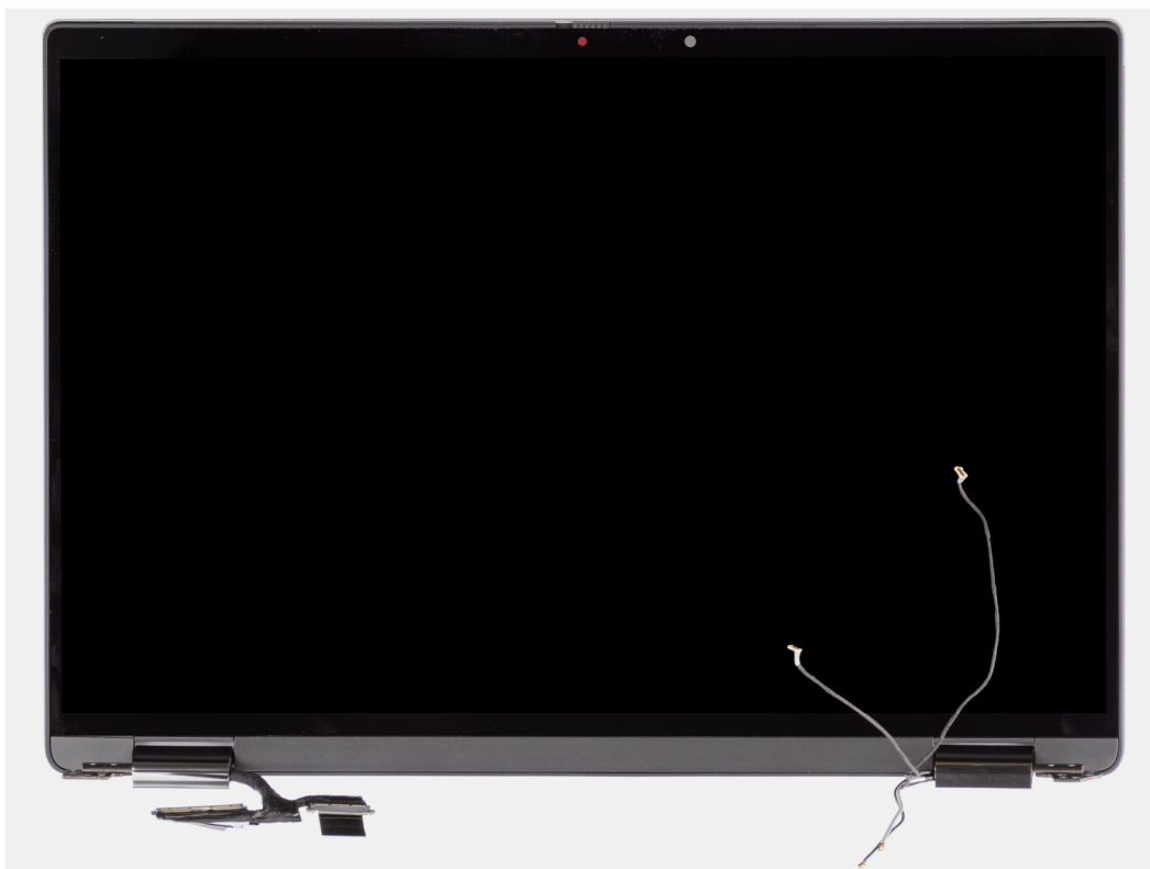
Figur 48. Bildskärmsenhet med WWAN-antennkablar
