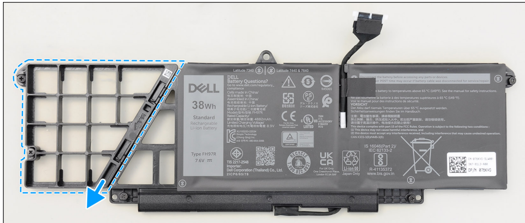
Figur 35. Ta bort 2-cellsbatteriet
