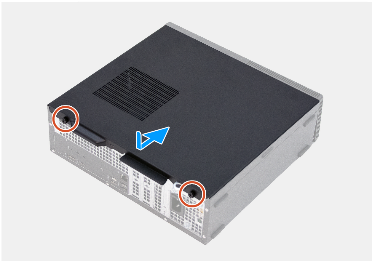
Figur 11. Installera den vänstra kåpan
