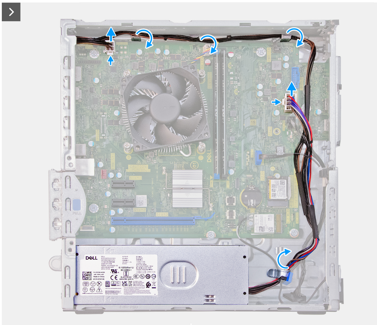
Figur 33. Ta bort nätaggregatet
