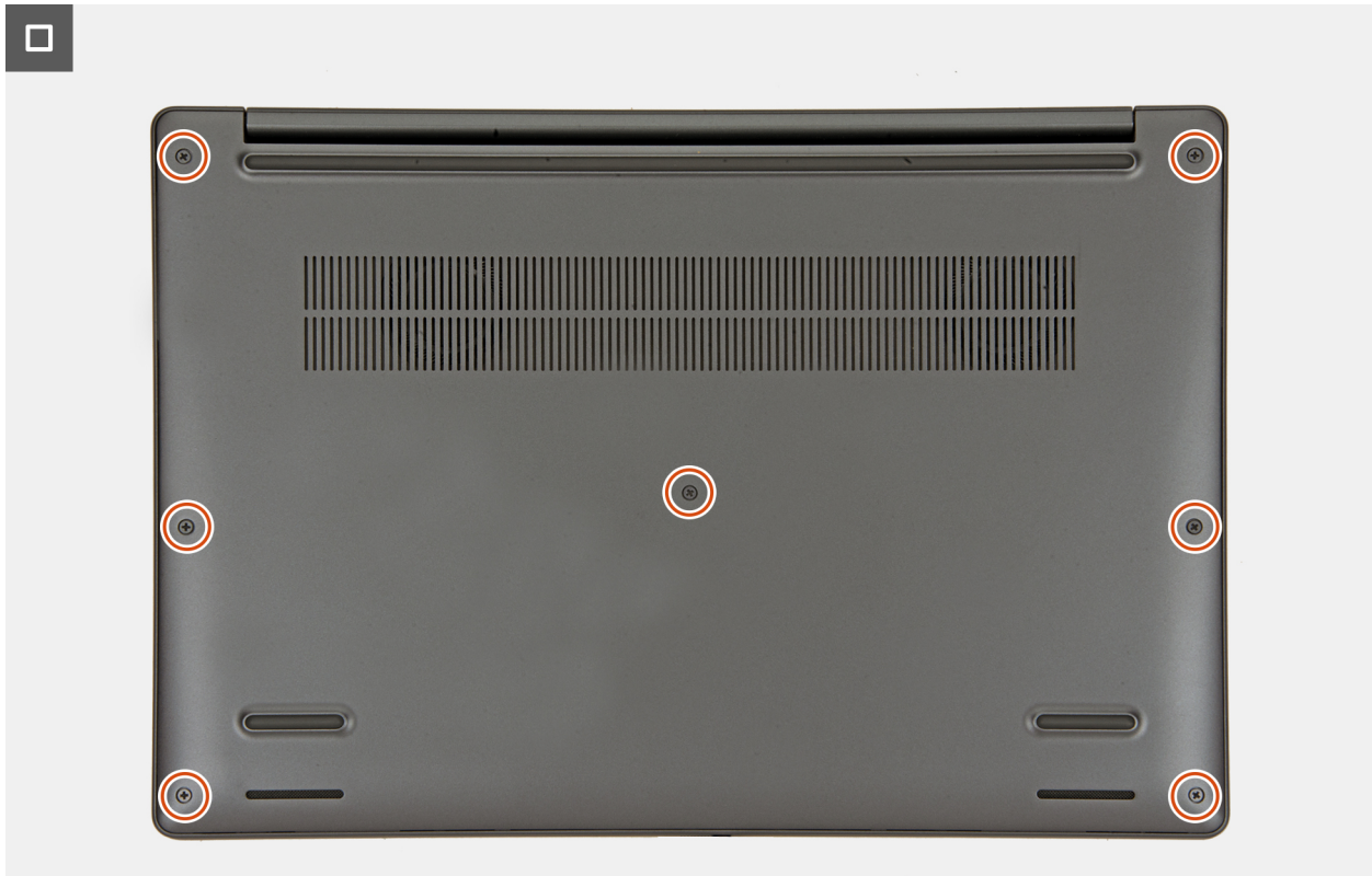
Figur 21. Dra åt fästskruvarna
