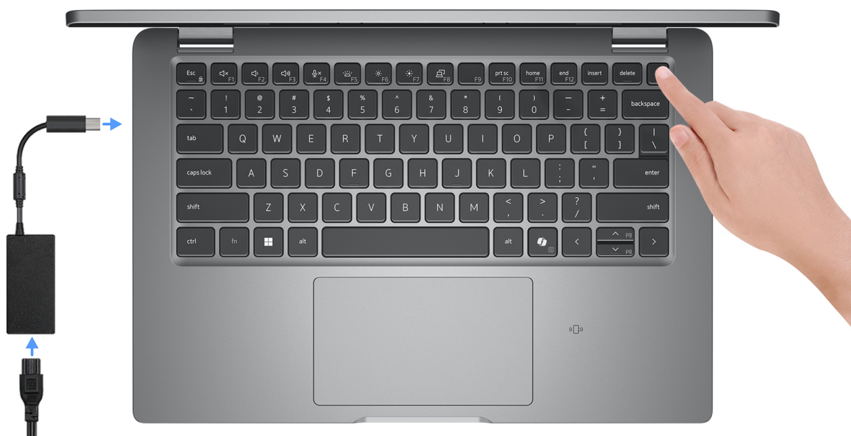
Figur 12. Anslut nätaggregatet och tryck på strömbrytaren
