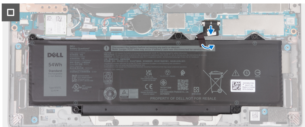
Figur 19. Koppla bort batterikabeln från moderkortet
