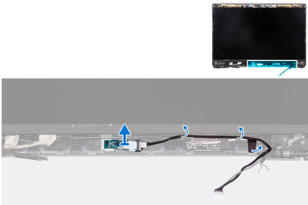
Figur 86. Ta bort sensorkortet (bärbar dator)
