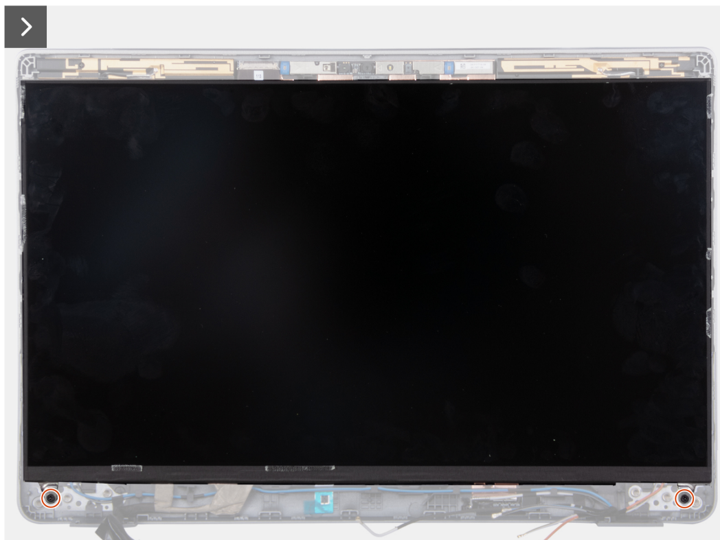
Figur 72. Ta bort bildskärmen (bärbar dator)
