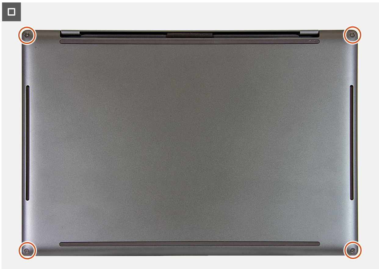
Figur 8. Dra åt de fyra skruvarna (M2x3,9, Torx 5) som håller fast baskåpan i handledsstöds- och tangentbordsenheten
