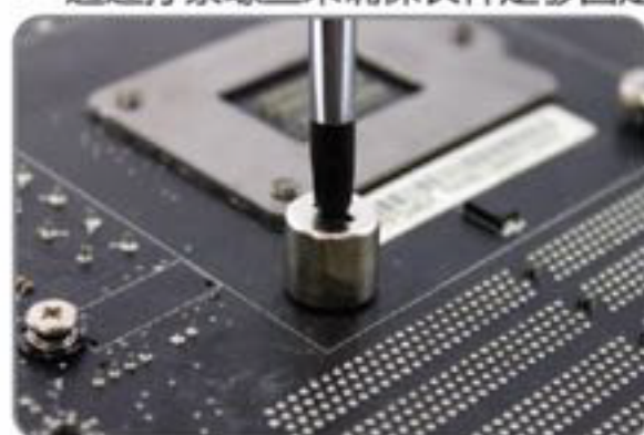
7 使用内六角套头加以适量拧紧 螺母
