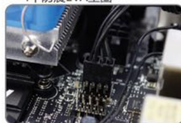
8 确保接上风扇的4pin供电接口
