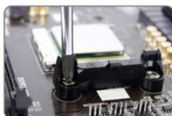
4 请将主板上原有的扣具完全拆开
