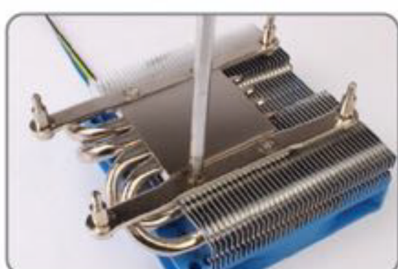
3 在散热器底部安装上两根固定长杆 通过拧紧螺丝来确保长杆足够固定
