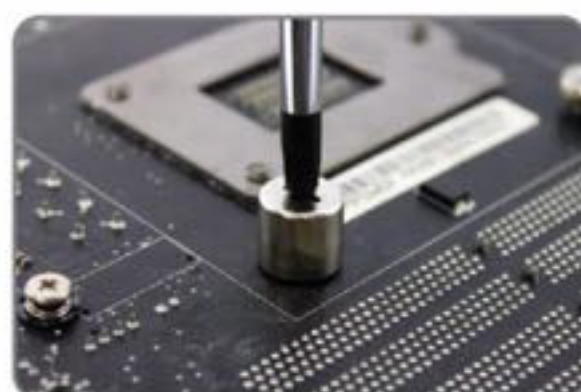
8 使用内六角套头加以适量拧紧 螺母
