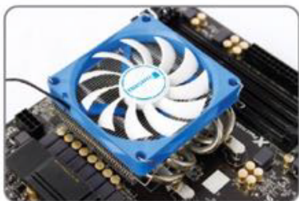
6 把固定长杆上的螺丝对准，穿过 主板固定孔位
