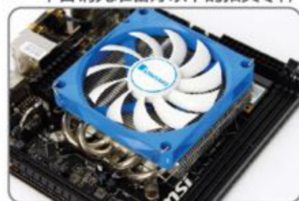
5 把固定长杆上的螺丝位置调整 至合适的孔距，螺丝对准穿过 主板固定孔位
