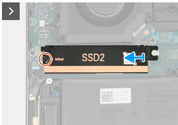
Figur 23. Ta bort M.2 2280 SSD-disken (SSD2)
