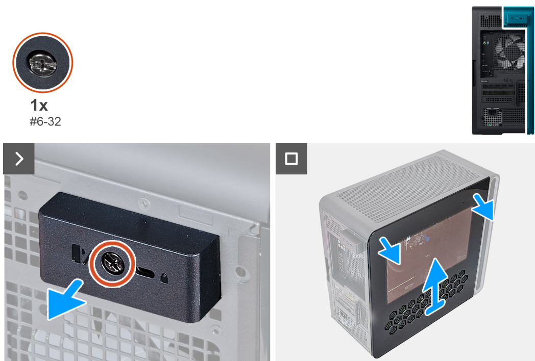
Figur 14. Ta bort den vänstra kåpan
