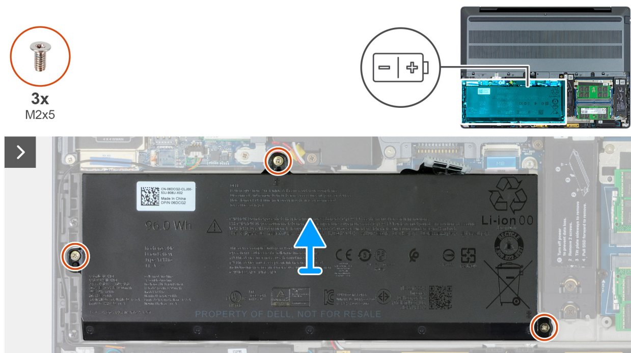
Figur 42. Ta bort batteriet
