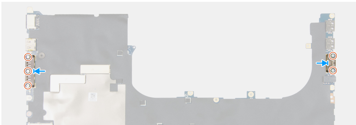
Figur 118. Installera USB Type-C-kontaktmodulen
