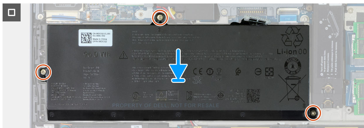
Figur 45. Byta ut batteriet
