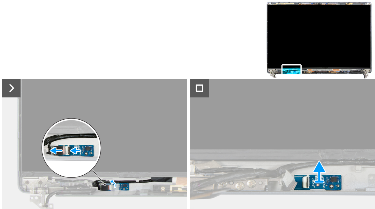
Figur 101. Ta bort sensorkortet
