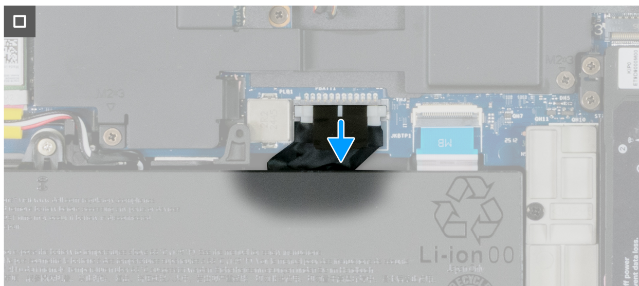
Figur 26. Koppla bort batterikabeln
