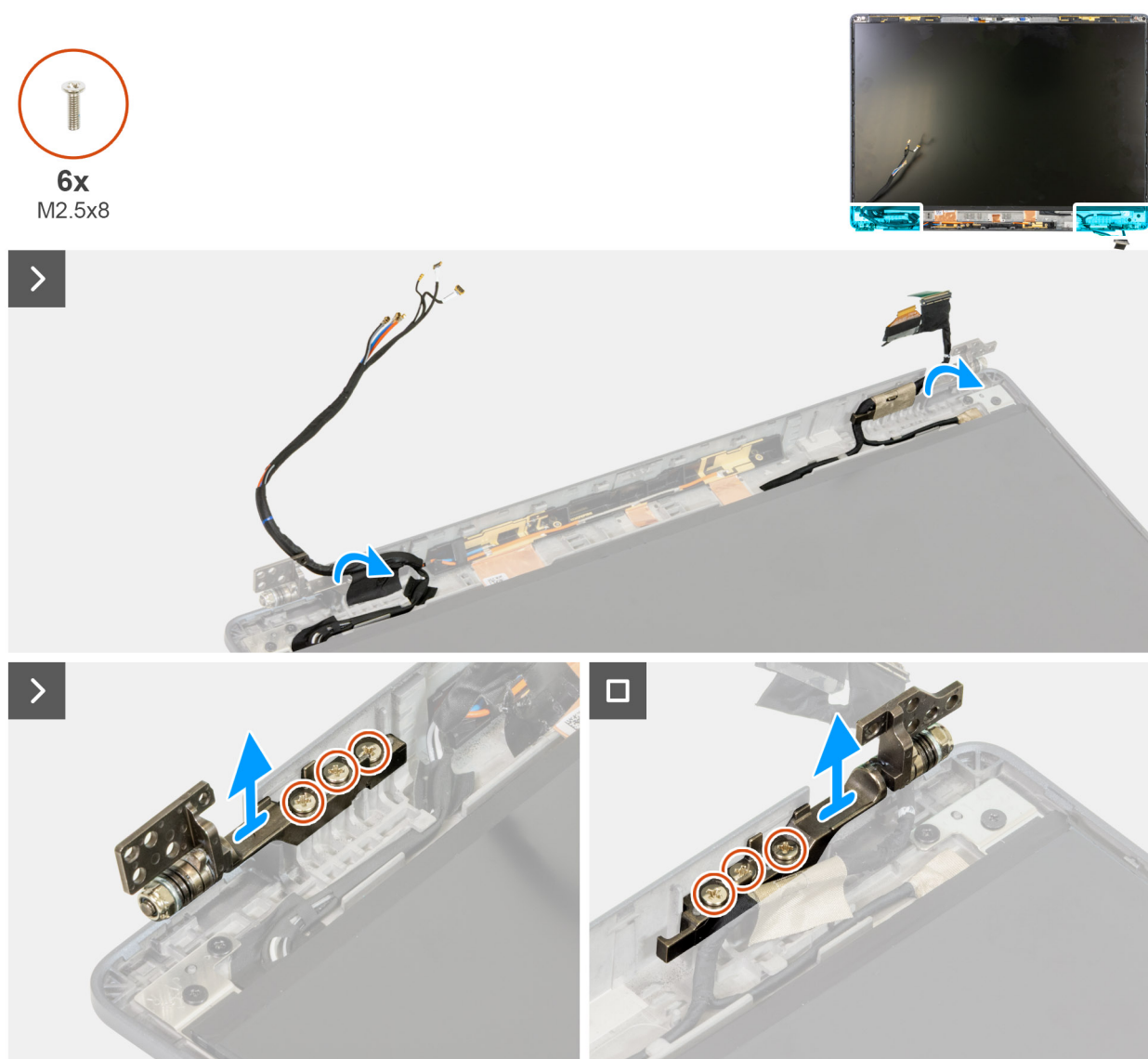
Figur 99. Ta bort bildskärmsgångjärnen
