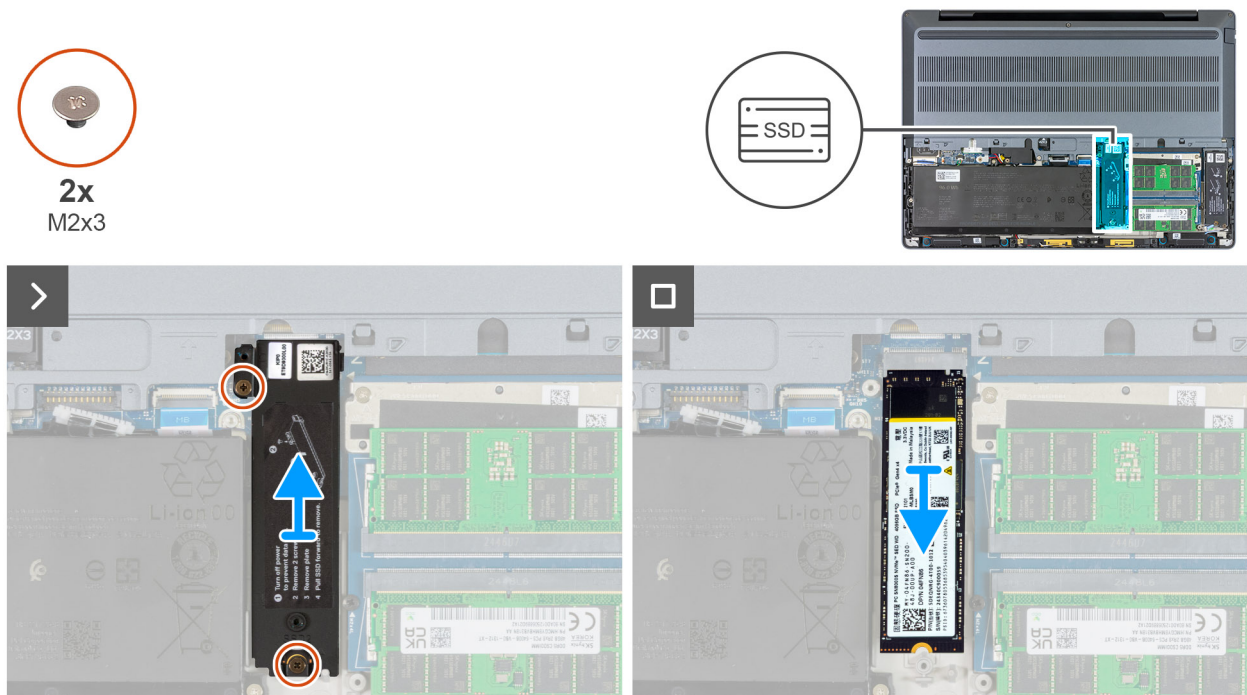
Figur 38. Ta bort M.2 2280 SSD-disken från kortplats 2 (SSD2)
