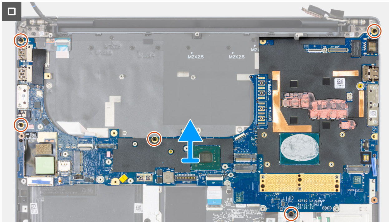
Figur 112. Ta bort moderkortet
