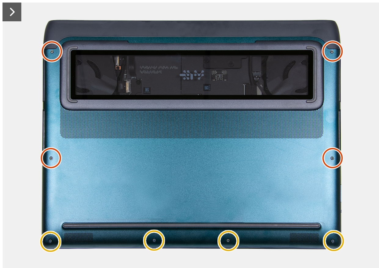
Figur 9. Ta bort skruven på baskåpan
