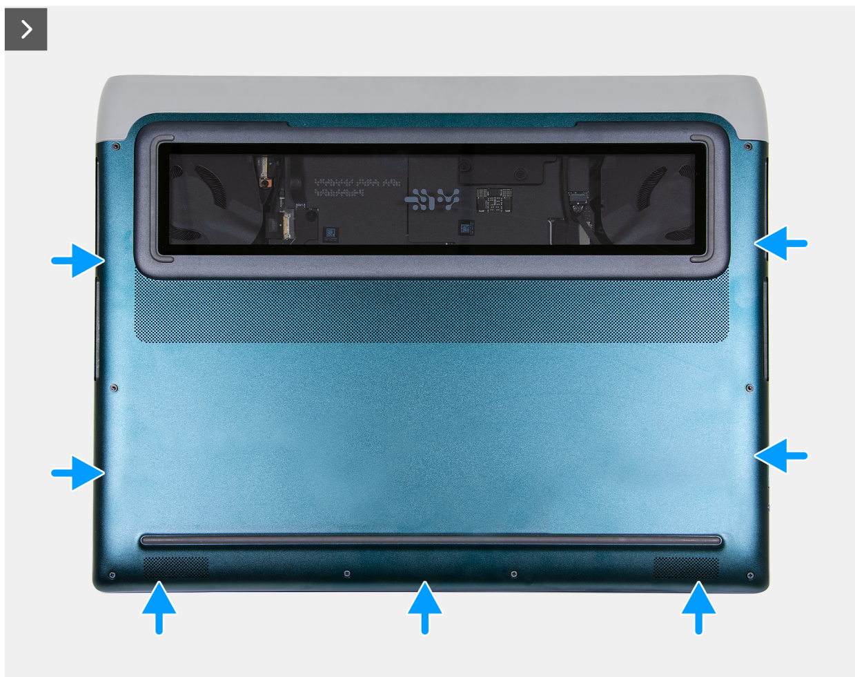
Figur 15. Snäppa fast baskåpan på plats
