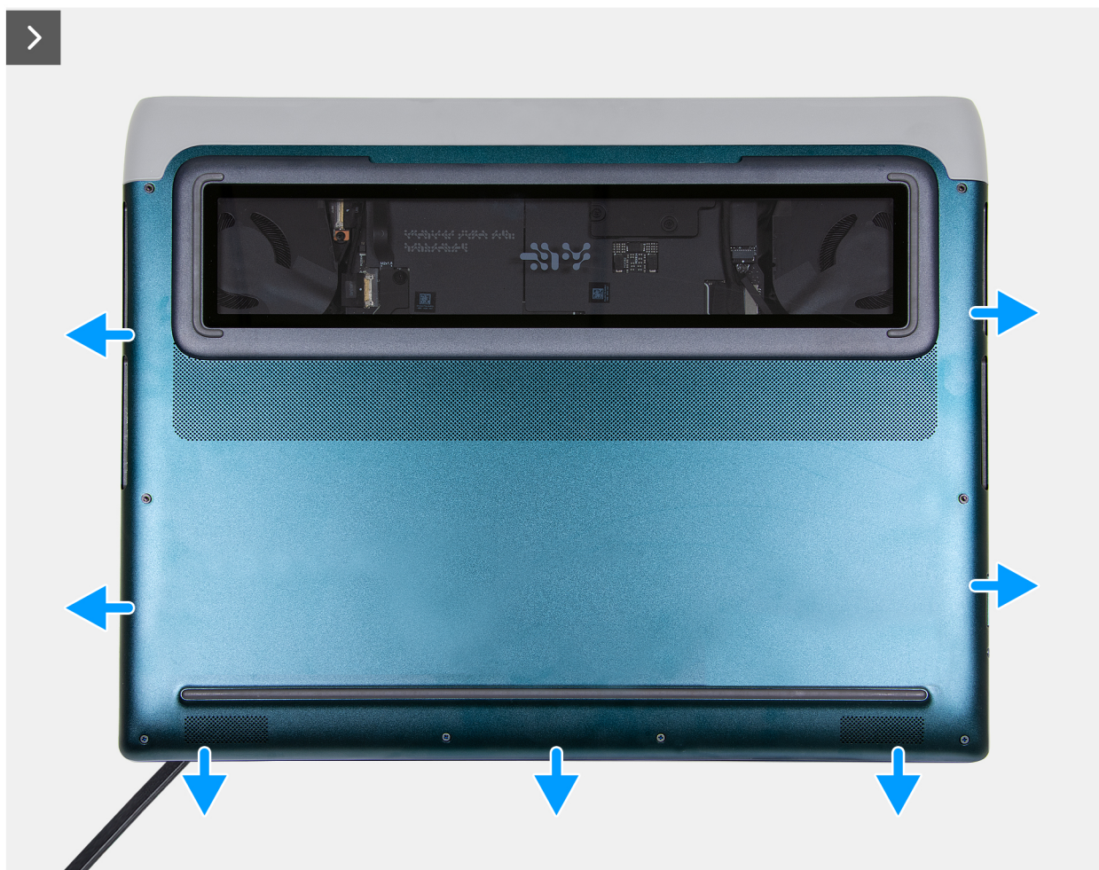
Figur 10. Bända loss baskåpan
