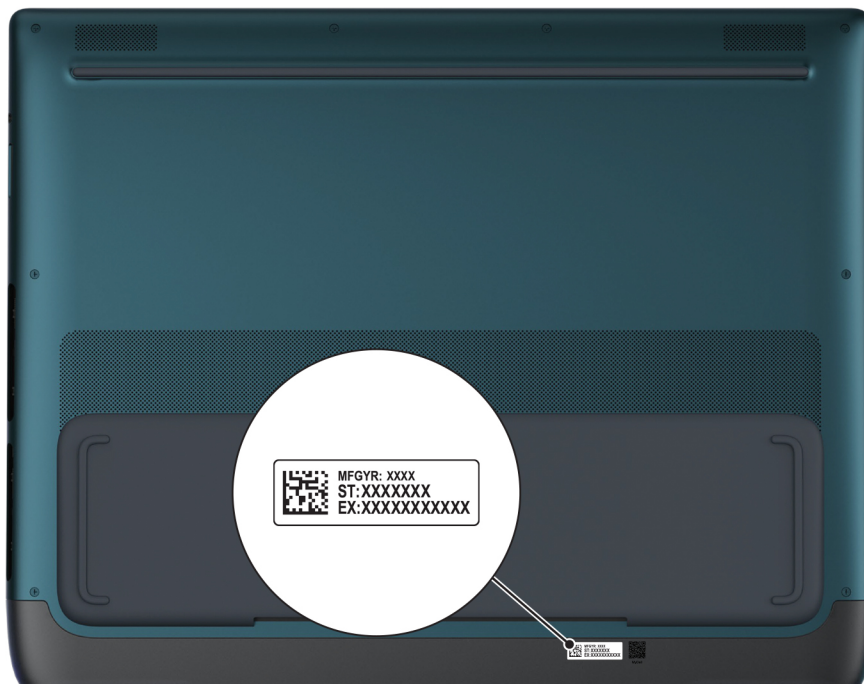
Figur 5. Plats för service tag eller expresstjänstkod
