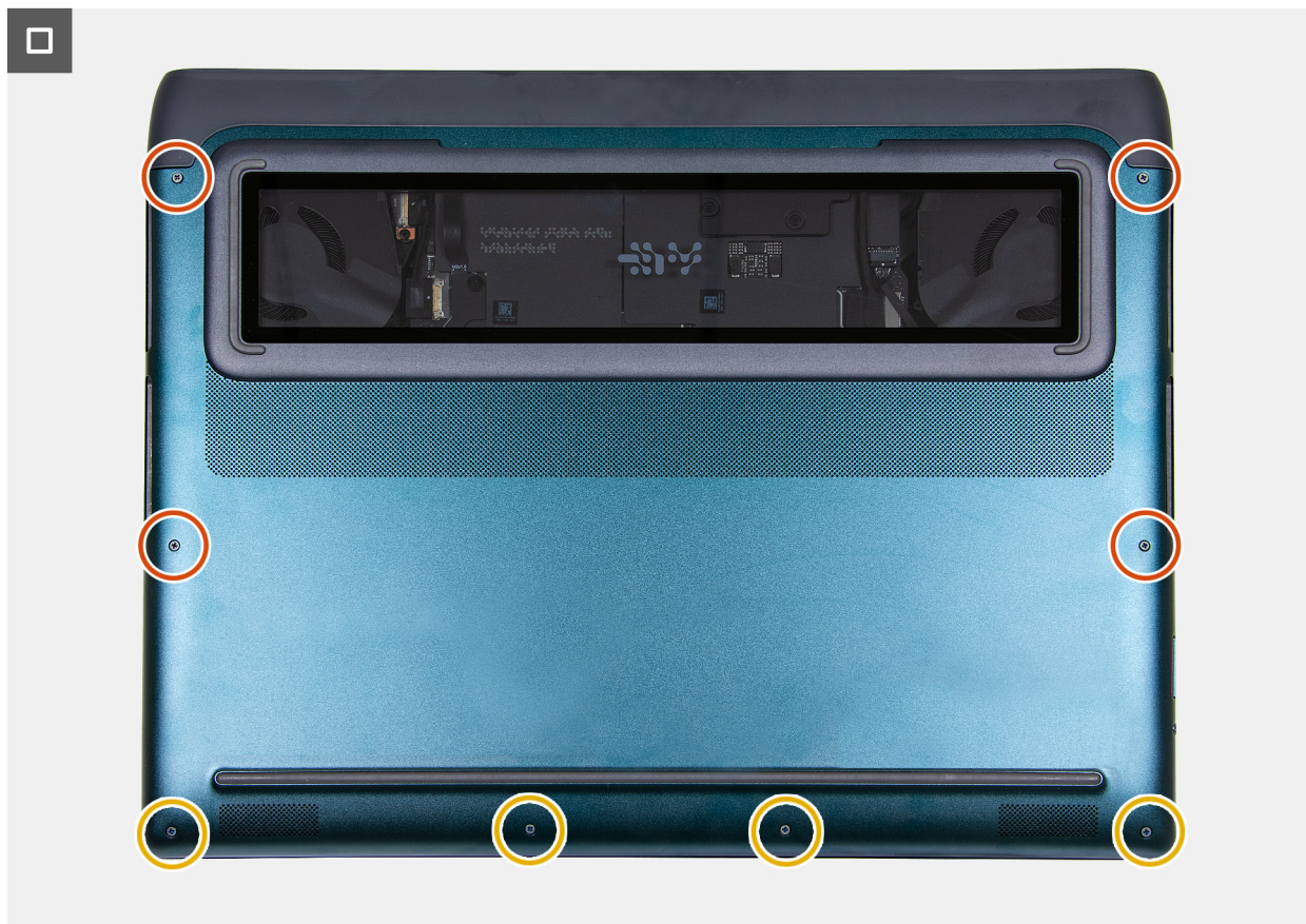
Figur 16. Sätta tillbaka skruvarna på baskåpan
