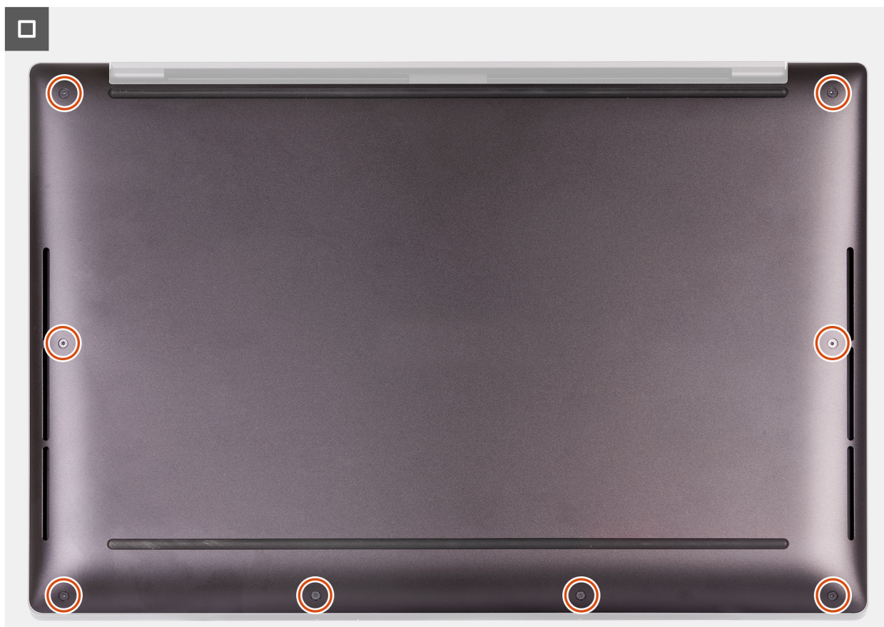
Figur 8. Dra åt de åtta skruvarna som fäster kåpan i handledsstödet
