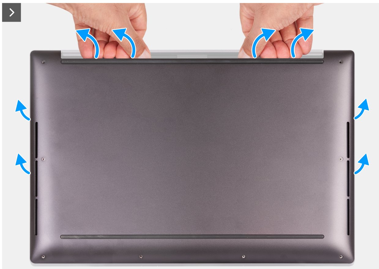
Figur 2. Bända loss baskåpan med tummarna
