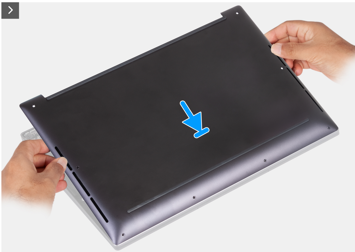
Figur 6. Placera baskåpan i spåren på handledsstödet
