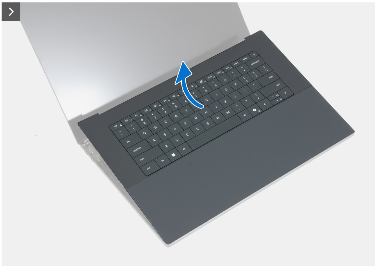
Figur 4. Lyft försiktigt bort handledsstöds- och tangentbordsenheten från baskåpan
