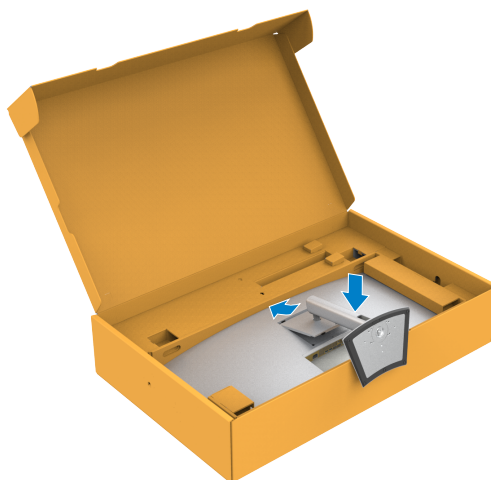
Figur 16. Skjut in flikarna på höjledsjusteringen i spåren
