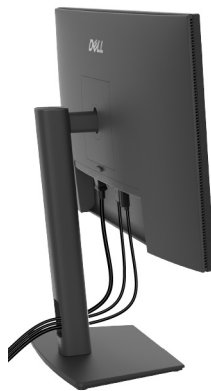
Bild 29. Se till att sörja för tillräckligt med slak kabel för att kunna flytta bildskärmen
