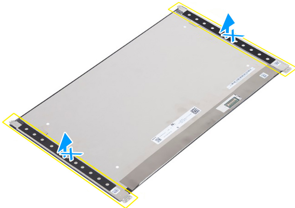
Figur 79. Dra inte och lossa Sr-tejpen (Stretch Release) från bildskärmen.
