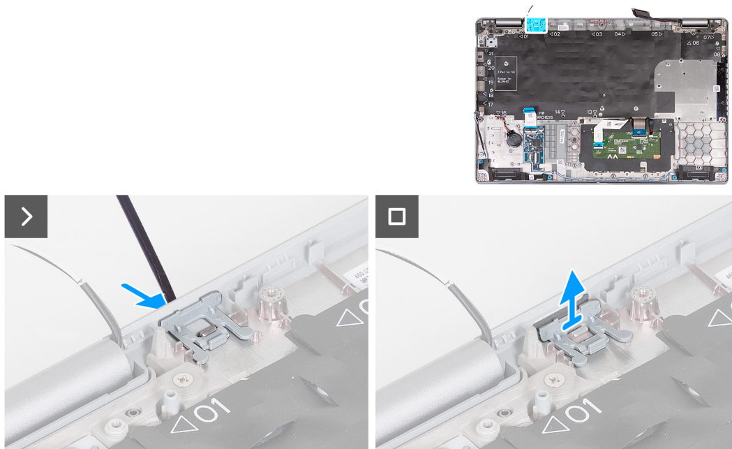
Figur 98. Ta bort SIM-kortsplatshållaren
