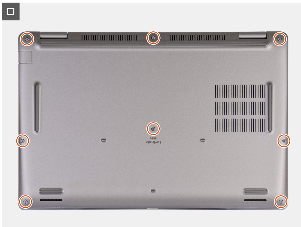
Figur 18. Dra åt fästskruvarna
