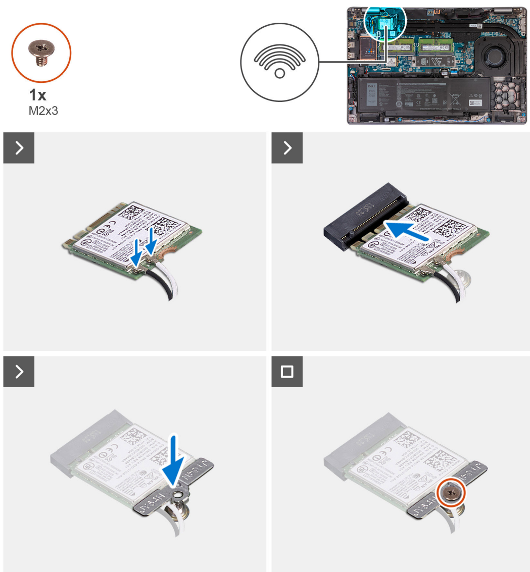
Figur 20. Installera det trådlösa kortet
