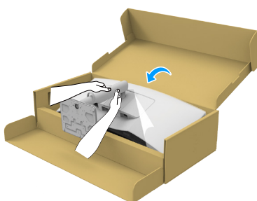
Bild 15. Håll i stativet och lyft skärmen
