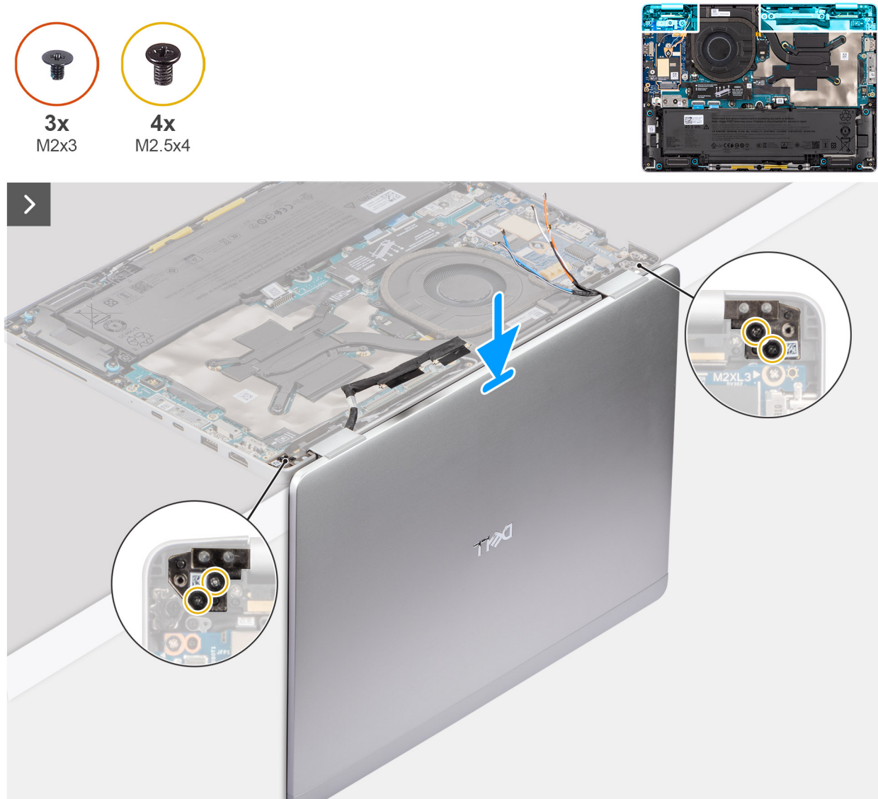
Figur 59. Rikta in bildskärmsenheten mot handledsstödsenheten
