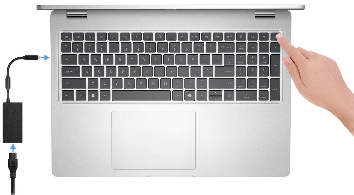
Figur 11. Anslut nätaggregatet och tryck på strömbrytaren
