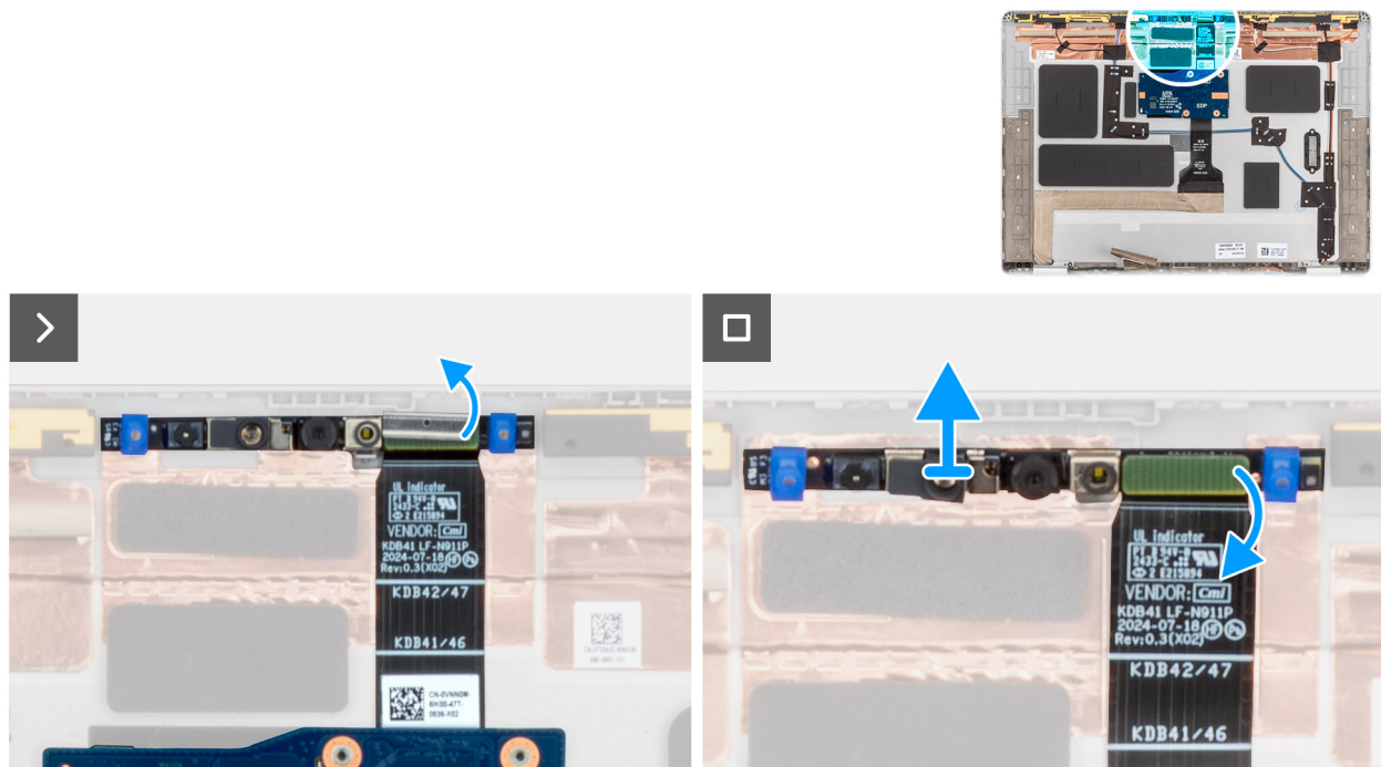
Figur 79. Ta bort MIPI-kameran
