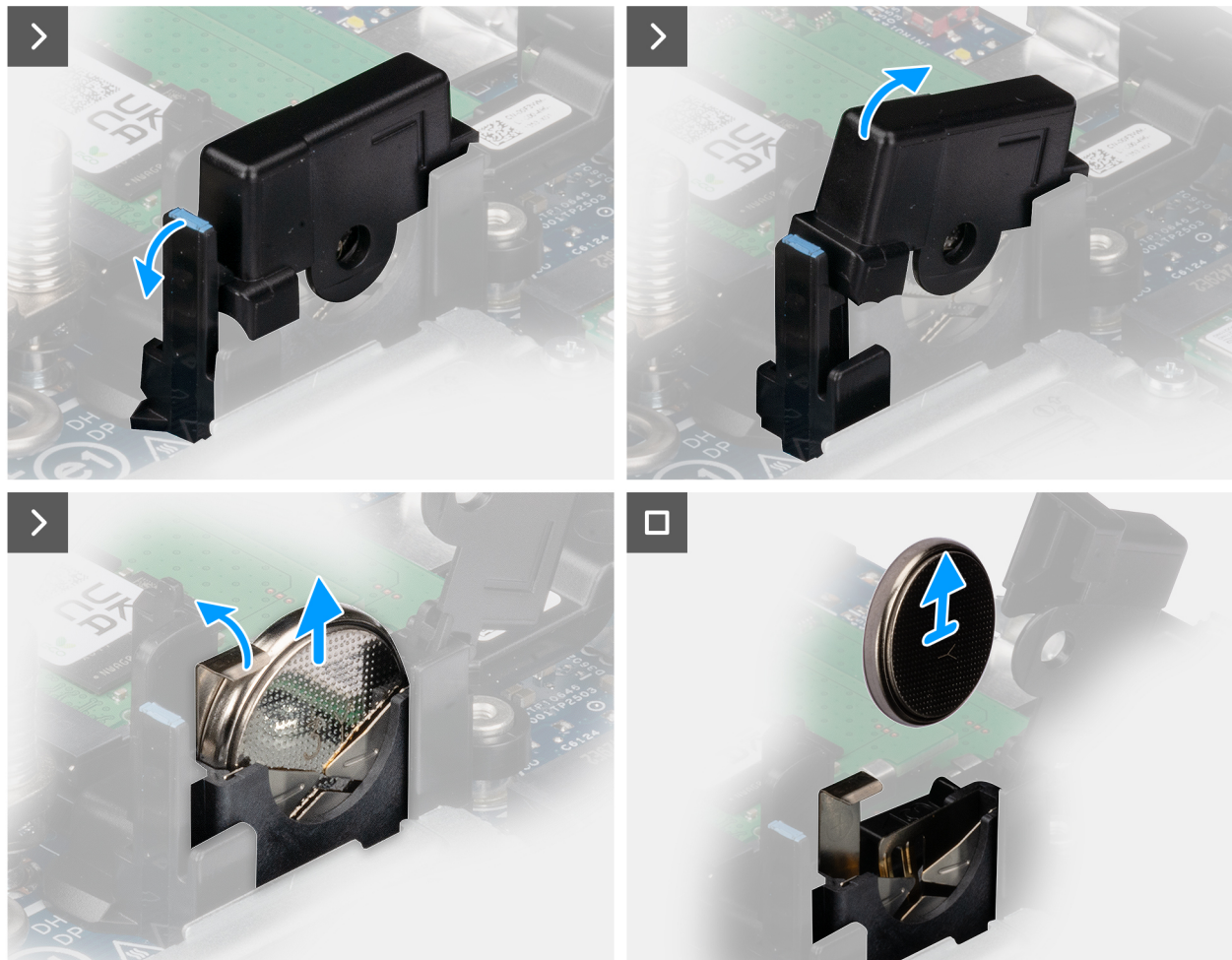
Figur 7. Ta bort knappcells batteriet
