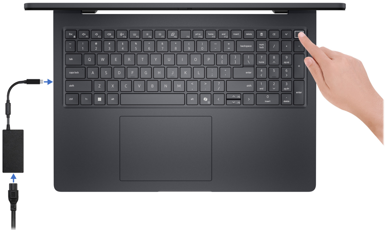
Figur 8. Anslut nätaggregatet och tryck på strömbrytaren
