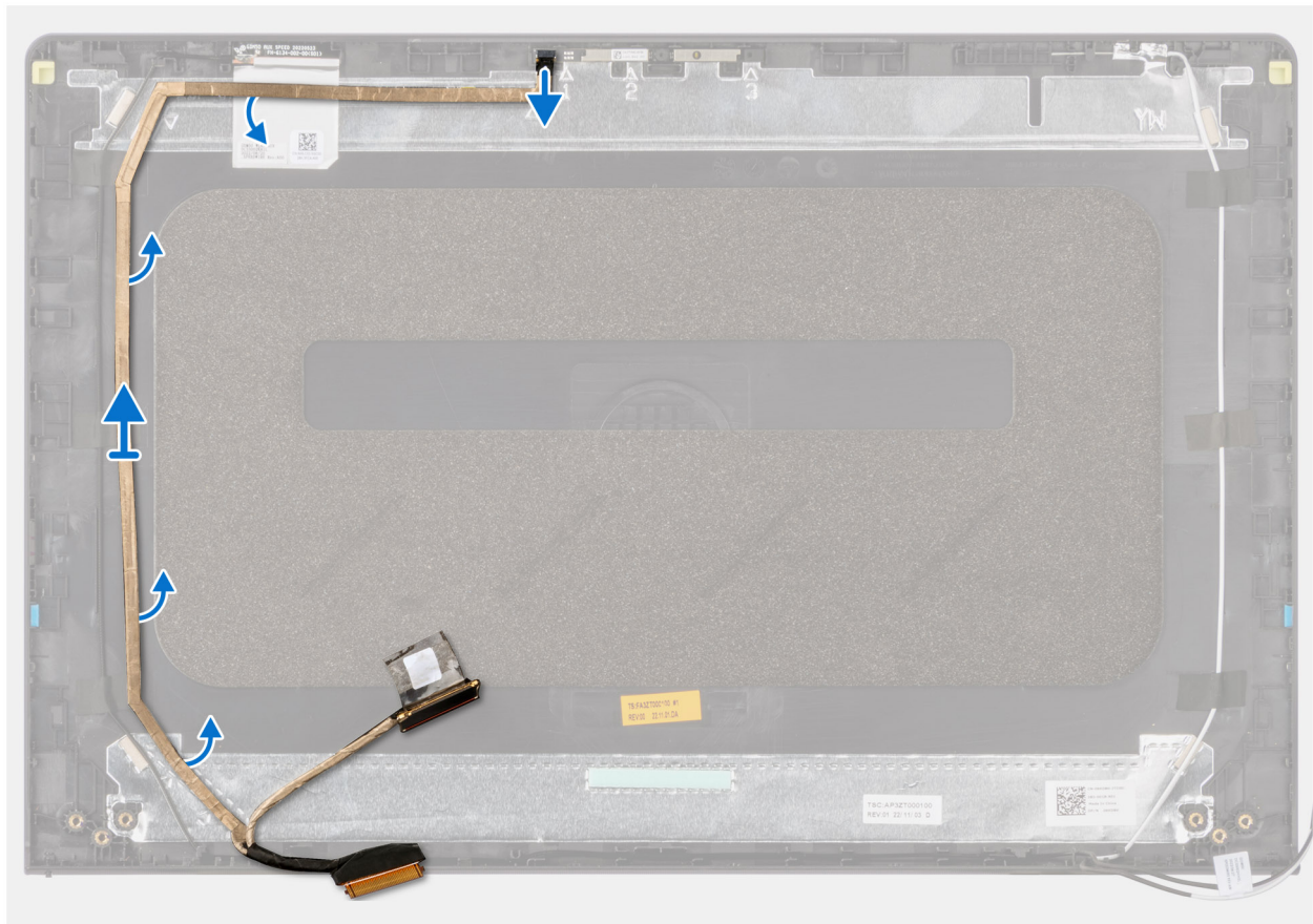
Figur 60. Ta bort bildskärmskabeln
