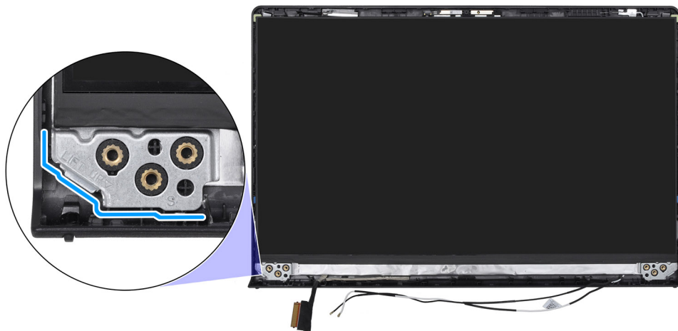
Figur 51. Bänd bort bildskärmsenheten från det vänstra fästet
