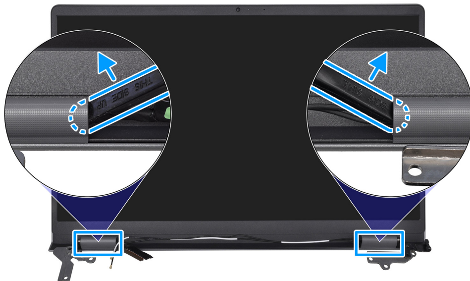
Figur 40. Bända bort bildskärmsgångjärnen
