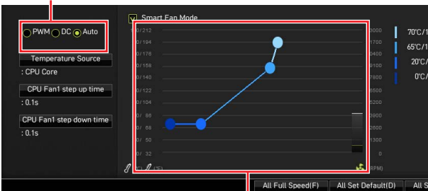
風扇速度的漸變點，允許您根據 CPU 溫度調整風扇速度。
