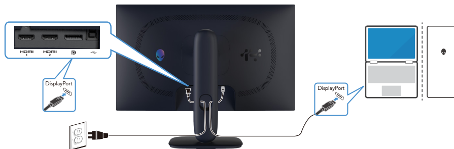
Figure 28. Ansluta DisplayPort-kabeln (DP till DP)
