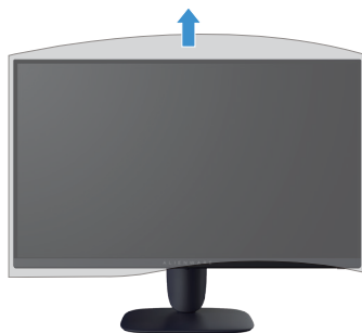
Figure 18. Lyft skyddskåpan från bildskärmen
