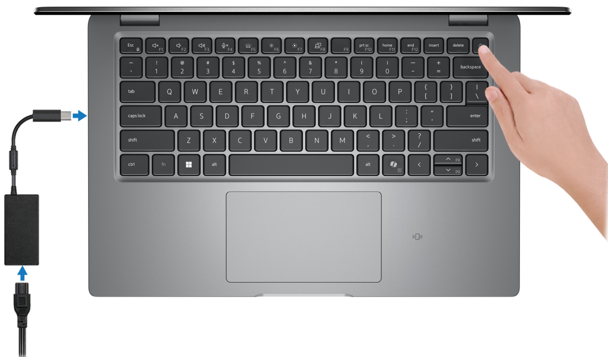
Figur 1. Anslut nätaggregatet och tryck på strömbrytaren
