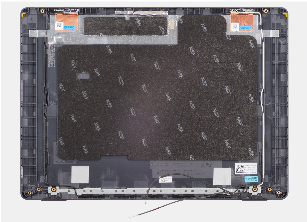
Figur 124. Montera bildskärmens baksida
