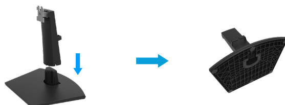
Bild 12. Montera bildskärmens stativ
