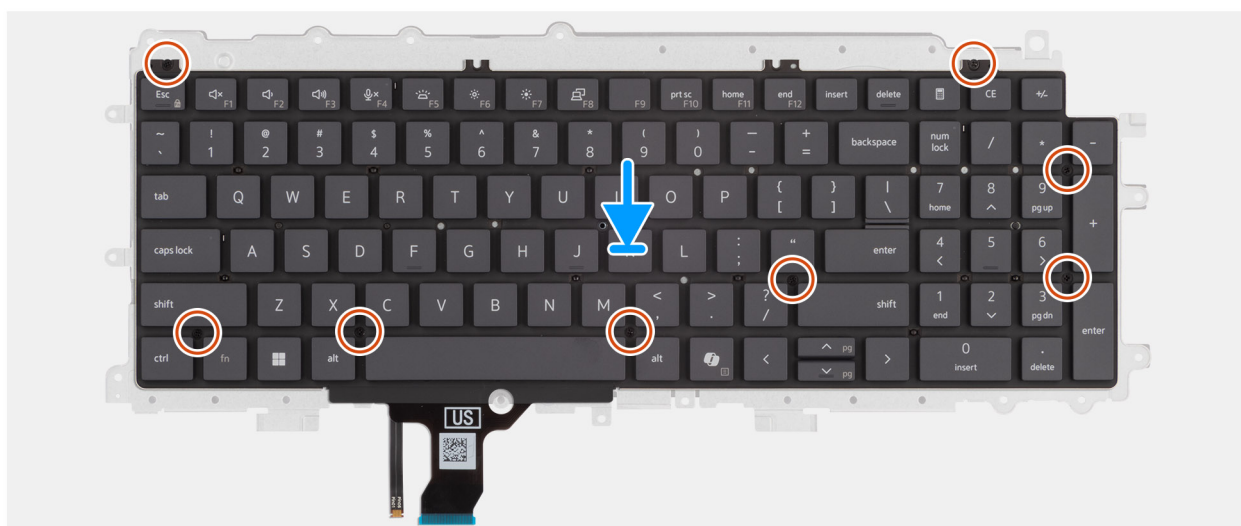
Figur 88. Installera tangentbordets stödplatta
