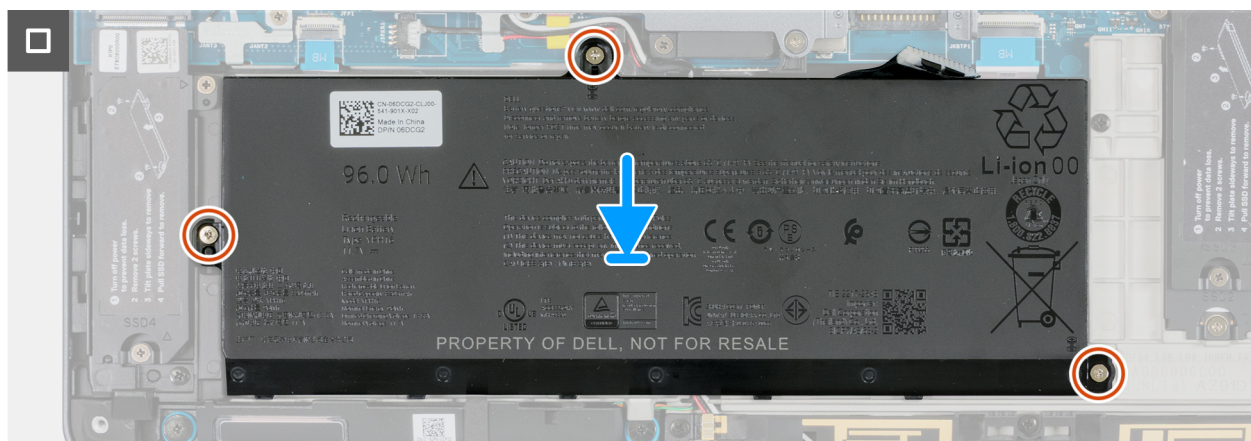
Figur 47. Byta ut batteriet
